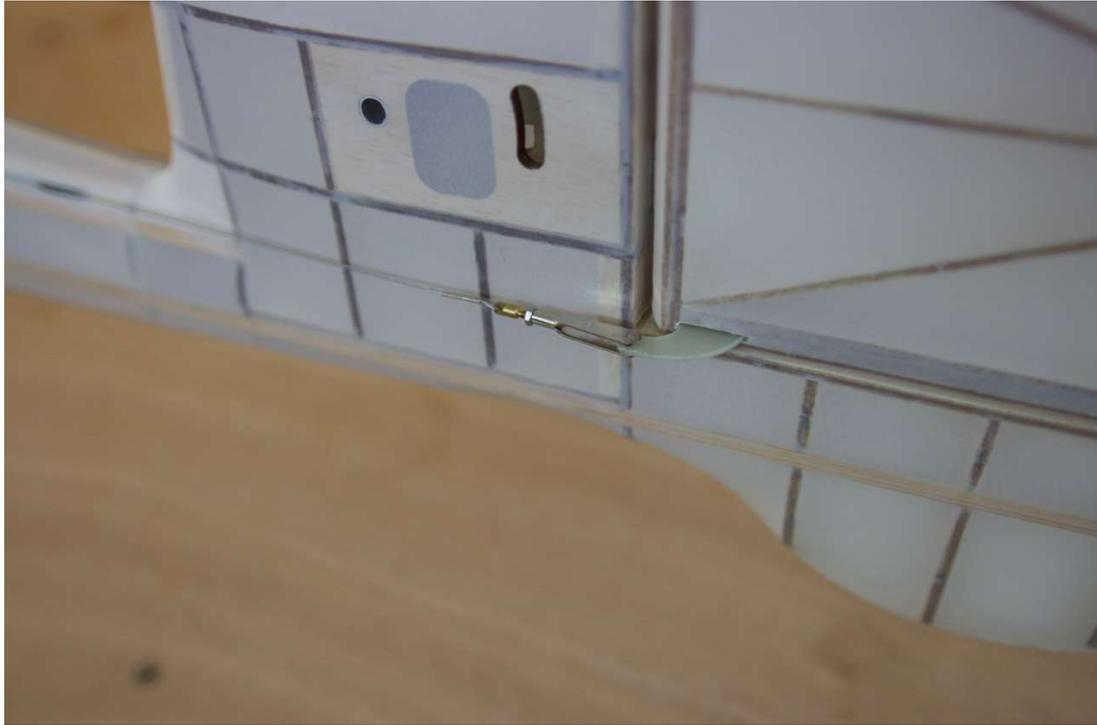
Collez le patin en inox à la colle contact prépercez les trous avec une mèche de 1mm de diamètre et vissez le en place avec les vis têtes fraisées de 2.2x9.5mm.
